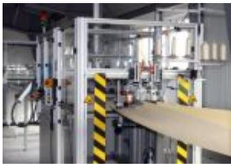
Am 10. Oktober 2014 erfolgte die Übergabe und Inbetriebnahme des neuen Nähautomaten durch die Firma KSL. Mit dieser Anlage haben wir nun die Möglichkeit, in Abhängigkeit von der Länge und Ausführung täglich bis zu 1.500 Schläuche oder Taschen zu produzieren. Hierbei sind Schlauchlängen bis zu 12 m und einem Ø von 350mm möglich. Somit sind wir nun auch in der Lage, größere Aufträge in kurzer Zeit und hoher Qualität zu erledigen.
